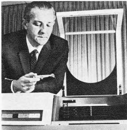
Bild 11. Ein Zugriffsarm ist aus dem Magnetplattenspeicher herausgenommen
