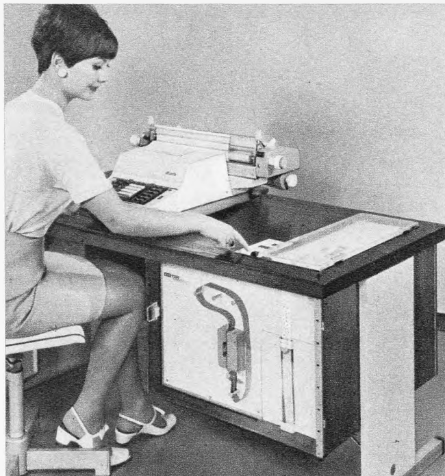
Bild 3. Buchungsautomat Ascota 071 L mit 2 bis 6 Soldererwerken, automatischer Saldensortierung und Nullkontrolleinrichtung, Generalumkehraste zur sofortigen Fehlerberichtigung und mit Lochstreifen Ausgabe zur automatischen Gewinnung numerischer Datenträger (VEB Buchungsmaschinenwerk)
